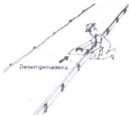
Figura 3 – Acabamento com desempenadeira
